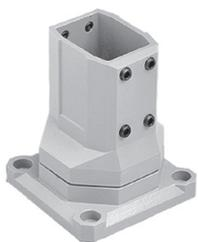
La plage de rotation est de 300 degrés. Le pied en aluminium moulé est recouvert d'une peinture gris clair (RAL 7035) en poudre de polyester. Vis de butée et joint fournis. Éléments de fixation non fournis.
