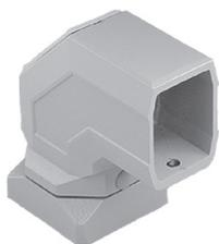
La plage de rotation est de 300 degrés. Le roulement à billes sans entretien est en acier et en polyamide. Le raccord comprend une plaque d'accès pour faciliter le passage des câbles. En aluminium moulé, il est recouvert d'une peinture gris clair (RAL 7035) en poudre de polyester. Éléments de fixation, supports et joint fournis.
