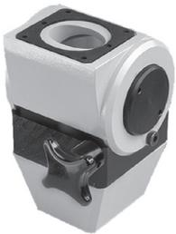
La fixation entre le bras porteur et le coffret IHM permet à l'opérateur de la machine d'utiliser les options de rotation et d'inclinaison. La fonction de rotation permet une rotation maximale de 300 degrés. La fonction d'inclinaison permet un réglage progressif, de la position horizontale jusqu'à 30 degrés. L'accouplement en aluminium moulé est recouvert d'une peinture gris clair (RAL 7035) en poudre de polyester. Éléments de fixation, supports et joint fournis.
