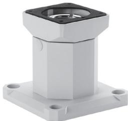
La plage de rotation est de 300 degrés. L'accouplement en aluminium moulé est recouvert d'une peinture gris clair (RAL 7035) en poudre de polyester. Vis de butée et joints fournis. Éléments de fixation non fournis.
