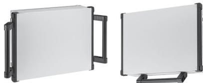
Kit de poignées pouvant être montées sur l'extrusion ou sur la partie inférieure du coffret. D'une longueur de 340,4 mm, la poignée peut être découpée pour s'adapter à des coffrets de petite taille. Le tube en aluminium est recouvert d'une peinture noire (RAL 9005) en poudre de polyester. Les embouts en plastique sont de teinte noire (RAL 9005). Le kit comporte une paire de poignées et tous les éléments de fixation.
