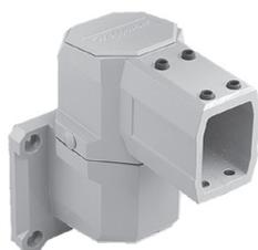
L'articulation comprend une plaque d'accès qui facilite le passage des câbles. La plage de rotation est de 300 degrés. L'articulation en aluminium moulé est recouverte d'une peinture gris clair (RAL 7035) en poudre de polyester. Vis de butée, joint et plaques d'accès amovibles fournis. Éléments de fixation non fournis.
