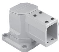
L'articulation comprend une plaque d'accès qui facilite le passage des câbles. La plage de rotation est de 300 degrés. L'articulation en aluminium moulé est recouverte d'une peinture gris clair (RAL 7035) en poudre de polyester. Vis de butée, joint et plaque d'accès amovible fournis. Éléments de fixation non fournis.
