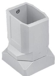
Rotation de 300 degrés possible. Le roulement à billes sans entretien est en acier et en polyamide. L'accouplement en aluminium moulé est recouvert d'une peinture gris clair (RAL 7035) en poudre de polyester. Éléments de fixation, supports et joint fournis.
