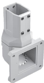
L'articulation verticale comprend une plaque d'accès qui facilite le passage des câbles. La plage de rotation est de 300 degrés. L'articulation en aluminium moulé est recouverte d'une peinture gris clair (RAL 7035) en poudre de polyester. Vis de butée, joint et plaque d'accès amovible fournis. Éléments de fixation non fournis.
