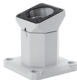
La plage de rotation est de 300 degrés. Le coffret est monté selon un angle de 15 degrés. L'accouplement en aluminium moulé est recouvert d'une peinture gris clair (RAL 7035) en poudre de polyester. Vis de butée et joints fournis. Éléments de fixation non fournis.
