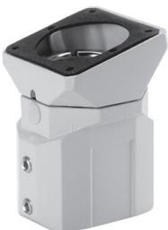
Rotation de 300 degrés possible. Le roulement à billes sans entretien est en acier et en polyamide. Le coffret est monté selon un angle de 15 degrés. L'accouplement en aluminium moulé est recouvert d'une peinture gris clair (RAL 7035) en poudre de polyester. Éléments de fixation, supports et joints fournis.
