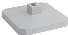
Le socle est une construction monobloc en aluminium moulé recouverte d'une peinture structurée gris clair (RAL 7035) en poudre de polyester. Toutes les pièces servant à la fixation des profilés de liaison sont fournies.
