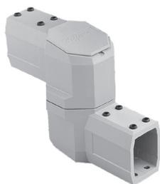
L'articulation en aluminium moulé est recouverte d'une peinture gris clair (RAL 7035) en poudre de polyester. La plage de rotation est de 360 degrés avec dispositif de blocage. L'articulation comprend des plaques d'accès facilitant le passage des câbles, des éléments de fixation et un joint. L'utilisation de l'articulation intermédiaire réduit la charge admissible du bras porteur de 43 %.
