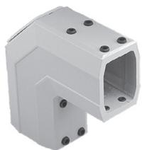
Le coude est en aluminium avec des parois renforcées, offrant ainsi une plus grande solidité et une charge admissible plus importante. Avec vis de butée pour l'alignement des profilés de liaison. Le coude en aluminium moulé est recouverte d'une peinture gris clair (RAL 7035) en poudre de polyester.
