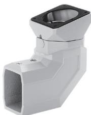
La plage de rotation est de 300 degrés. Le roulement à billes sans entretien est en acier et en polyamide. Le raccord comprend une plaque d'accès pour faciliter le passage des câbles. Le coffret est monté selon un angle de 15 degrés. L'accouplement en aluminium moulé est recouvert d'une peinture gris clair (RAL 7035) en poudre de polyester. Éléments de fixation, supports et joints fournis.
