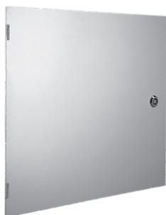
Les charnières des panneaux arrière peuvent être montées à gauche ou à droite du coffret. Selon les dimensions du coffret, celui-ci comporte une ou deux serrures à tourniquet. D'une épaisseur de 3 mm, le panneau arrière est en aluminium anodisé non peint avec une finition brossée. Les éléments de fixation et le kit de mise à la masse sont fournis.
